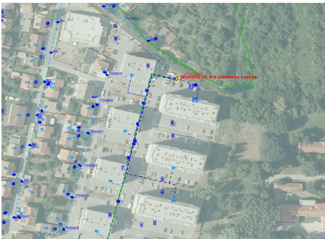
SI3. Topološki prikaz niskonaponske mreže napajane iz 2TS 2286
